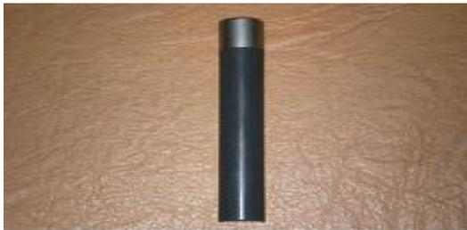
Рисунок 2.1 – Цилиндр с металлическим и эбонитовым наконечниками для исследования температурной чувствительности «Thio-therm»
