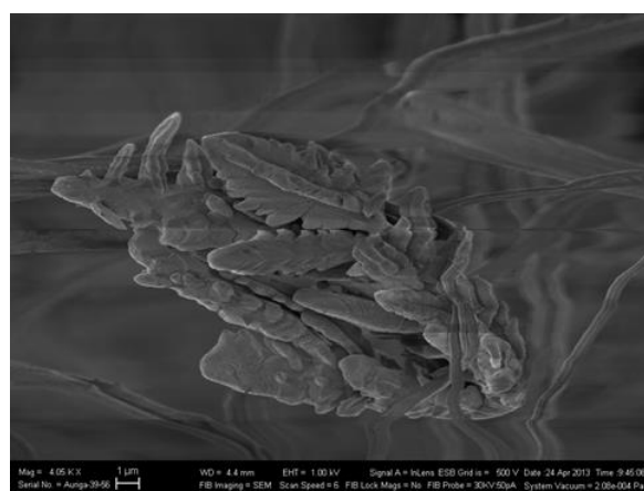
Рисунок 3 — Частицы аэрозоля в воздухе рабочей зоны. СЭМ-изображение, Mag - 4000x
